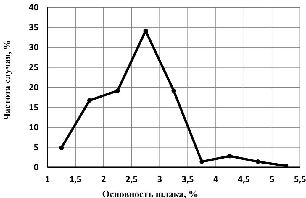
Рисунок 8 – Частотная кривая изменения основности печного шлака для стали 80К
