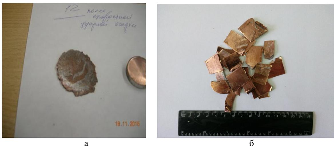
Рисунок 3 – Общий вид опытных образцов «чипс»-лигатуры: а – метод высокоскоростной деформации; б – метод прокатки
