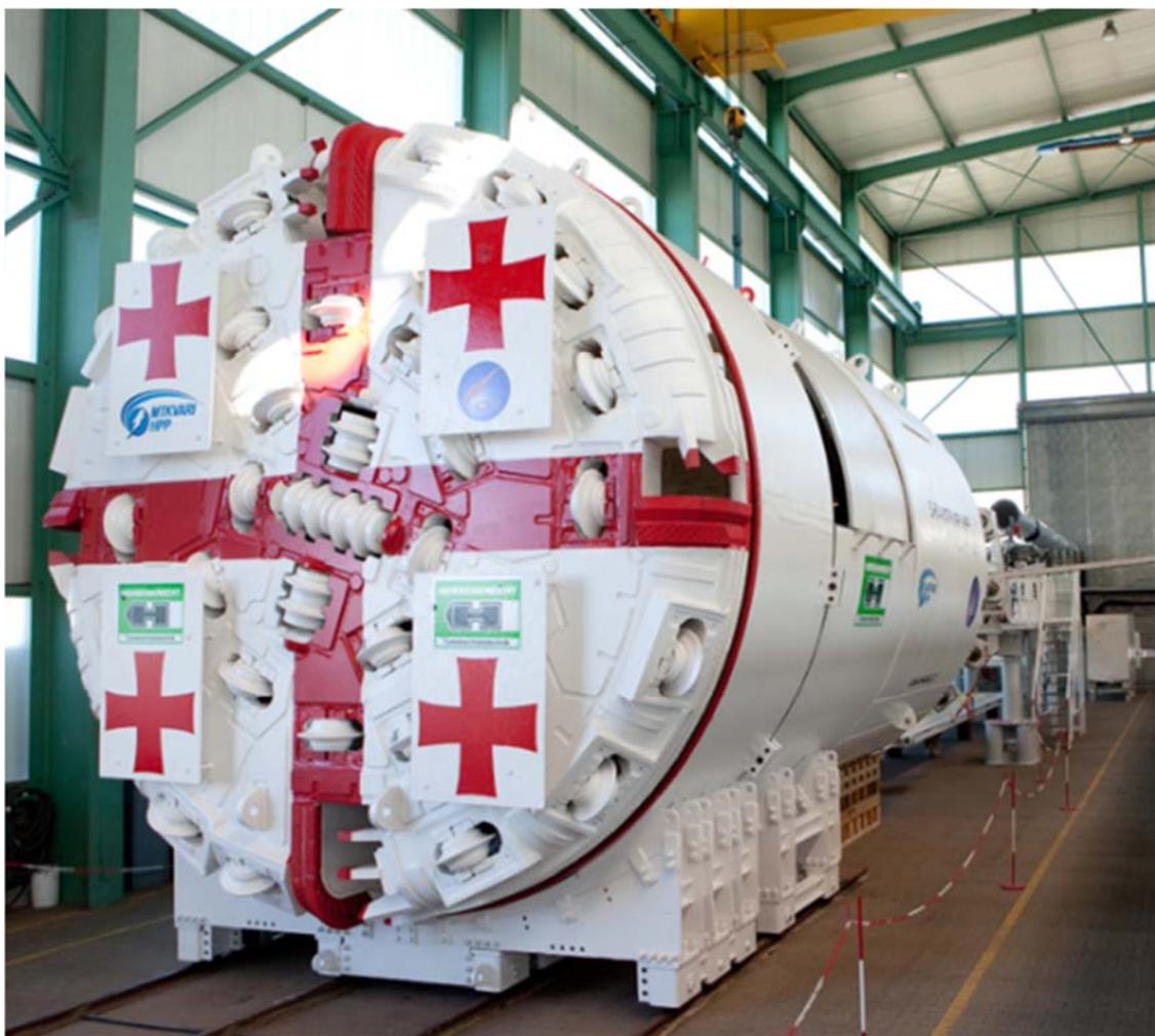
Рисунок 1 – Туннельно-расточная машина Herrenknecht S-424
