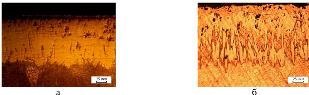
Рисунок 1 – Микроструктуры термодиффузионных однофазных боридных слоев:
