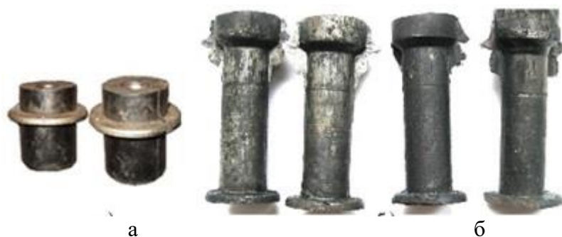
Рисунок 2 – Внешний вид биметаллических поковок, полученных с начальной скоростью деформирования 50 м/с: а – вставка пуансона; б – пуансон
