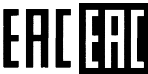
Рисунок 30 - Изображение единого знака обращения продукции на рынке государств-членов ТС [Евразийское соответствие (Eurasian Conformity)]
