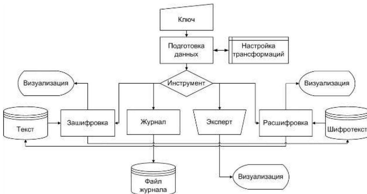
Рис. 1.13. Схема работы системы Visual AES
