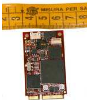
Рис. 2.5. Контроллер «Аккорд 5.5 mini-PCI-expre »
