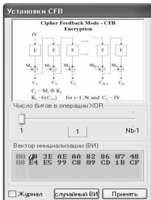
Рис. 1.17. Окна установок режима CFB программы Visual AES :
