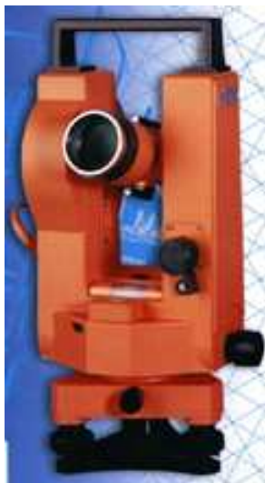
Рис. 8.12–А. Теодолиты ЗТ2КП / ЗТ5КП: точность 2" / 5"; увеличение зрительной трубы 30 х ; минимальное расстояние визирования 0,9 м; диапазон работы компенсатора вертикального круга 4' / 5'; масса 4,1 / 5 кг
