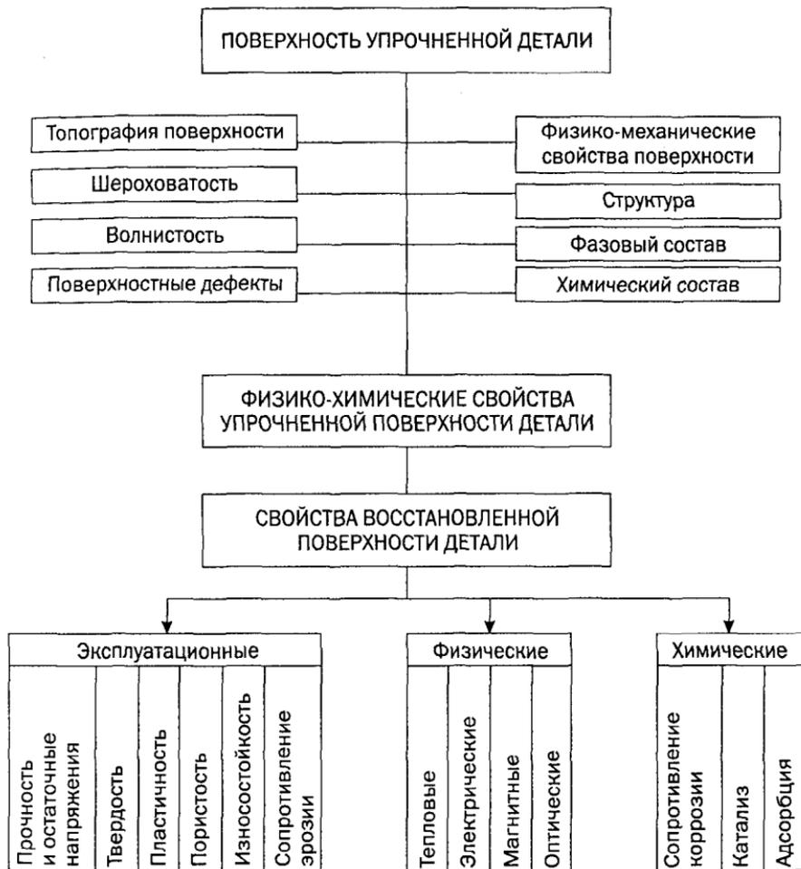
*Рис. 1.18. Схема связи активной восстановленной поверхности детали с физико-химическими и эксплуатационными свойствами.*
