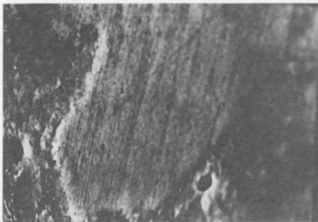
**Рис. 5.12 (окончание).** Фотографии микроструктуры упрочненного слоя при электромагнитной наплавке порошка С-300. Поперечный шлиф: в — растровая электронная микроскопия различных участков упрочненного слоя.
