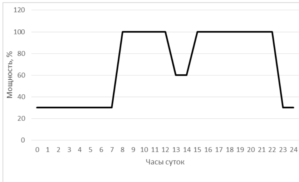
Рисунок 2. Проектный суточный график нагрузки французских АЭС с реакторами PWR
