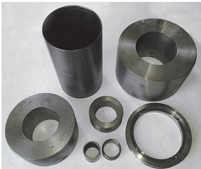
Рис. 3. Номенклатура заготовок и деталей, получаемых методом намораживания
