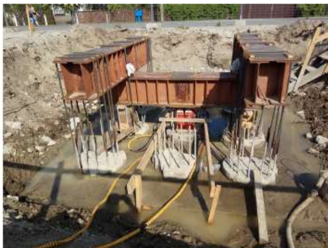
Схема испытания буровой сваи опоры №30
