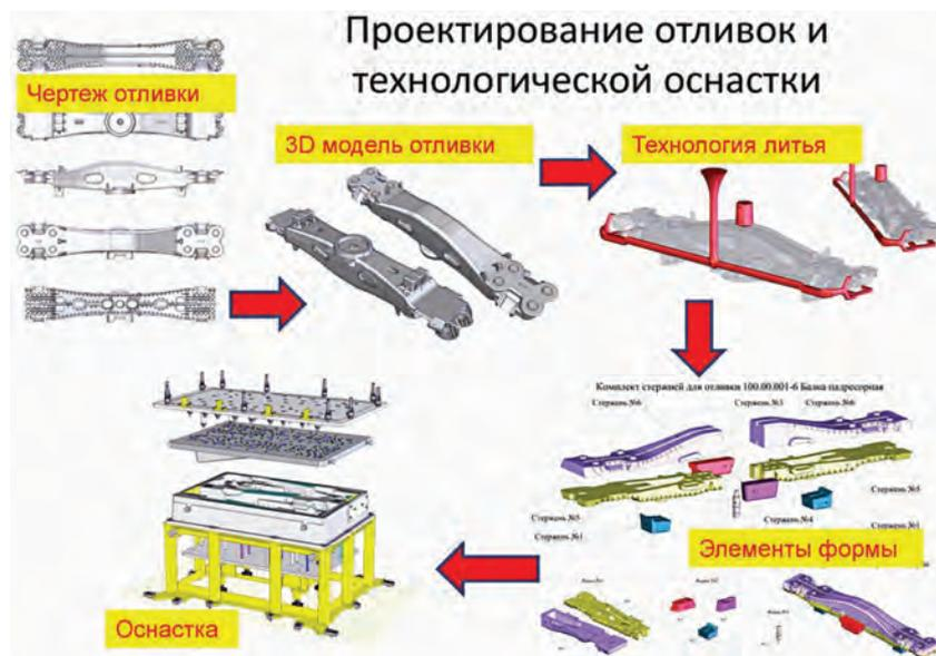
Рис. 4. Схема создания литейной технологической оснастки
