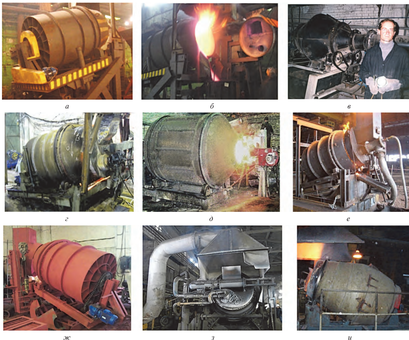
Рис. 3. Ротационные печи, разработанные УП «Технолит»: а, б – РНП-2,0, переработка стружки ГЛЗ «Центролит» (г. Гомель); в – С-03, сушка свинцового шлама ООО «Эрни» (г. Волковыск); г – РНП-3,0, рециклинг свинца ООО «Авангард-Юнион» (Владимирская обл., РФ); д – РНП-3,0 рециклинг свинца ООО «БелИнвестТорг» (г. Волковыск); е – РНП-0,5, рециклинг окалины БМЗ (г. Жлобин); ж – РНП-0,8, переработка железного огарка ООО «Карбона-Проминтех» (г. Пермь, РФ); з – РНП-9,0, рециклинг свинца ЗАО «КПВР СПЛАВ» (г. Рязань, РФ); и – РНП-1,5, рециклинг алюминиевых отходов «БелТОР 7» (г. Мозырь)
