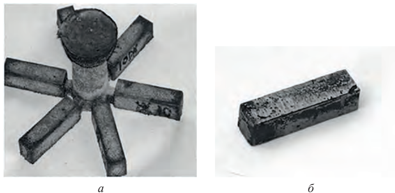
Рис. 1. Литые образцы (а), образец, подготовленный к испытаниям на износ (б)
