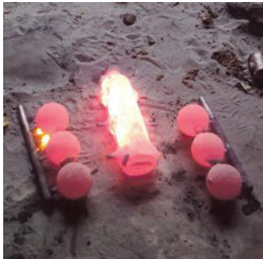
Рис. 3. Отлитые чугунные шары диаметром 100 мм с содержанием хрома 1% с литниковой системой и образцы шаров после испытаний
