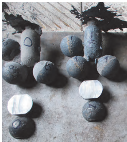
Рис. 5. Отлитые стальные шары диаметром 100 мм с содержанием углерода до 1% с литниковой системой ирезы шаров после испытаний
