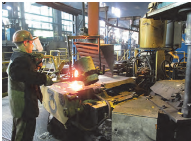
Рис. 6. Шестипозиционная карусельно-кокильная машина мод. 49108 для литья в облицованный кокиль. Позиция заливки
