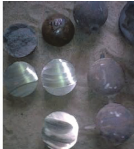
Рис. 3. Отлитые чугунные шары диаметром 100 мм с содержанием хрома 1% с литниковой системой и образцы шаров после испытаний
