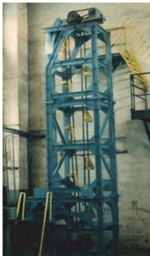
Рис. 2. Стенд П1755 для испытаний на ударную стойкость
