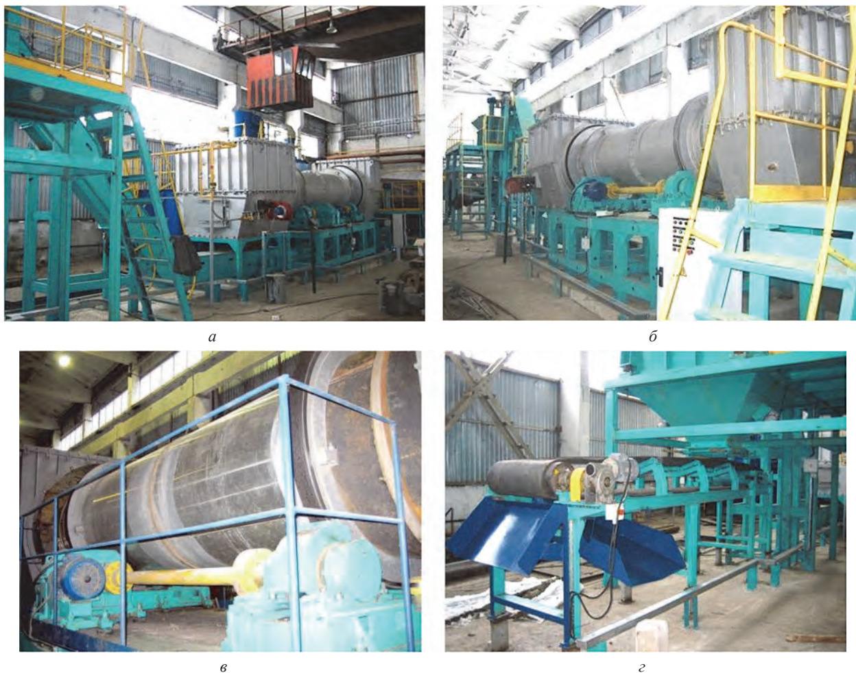
Рис. 4. Общий вид линии подготовки алюминиевой стружки к переплаву мод. 46178 (а, б) и ее отдельные узлы: сушильный барабан (в), магнитный сепаратор (г)
