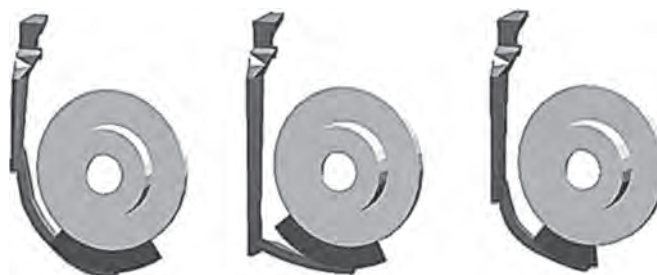
Рис. 3. Примеры литниковых систем с минимизацией турбулентности
