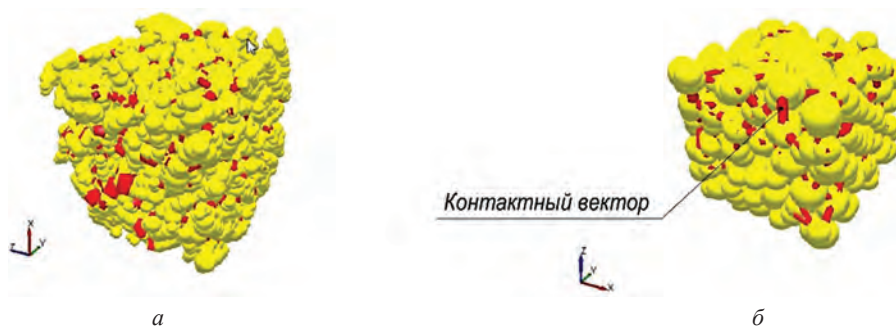
Рис. 4. Фрагменты моделей стержневой смеси в уплотненном состоянии зерен песка фракции 02: a – с применением угловатых зерен песка; б – с применением округлых зерен песка
