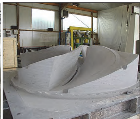
Прямое фрезерование блока из песчано-полимерной смеси (фирма EEW-PROTEC GmbH, Германия)
