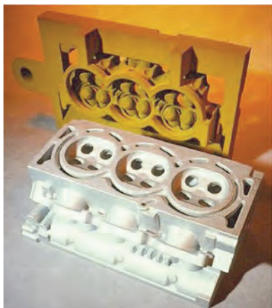
Стержень и литая заготовка (фирма EOS)
