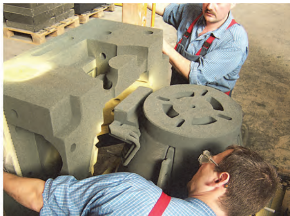
Сборка напечатанной формы (фирма ExOne)
