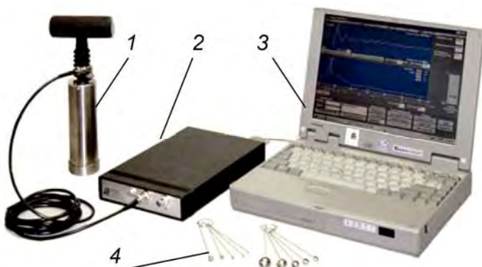
Рис. 1.23. Типичный комплект системы для оценки состояния бетонных изделий методом Impact-Echo: 1 – приемный акустический сенсор; 2 – блок усиления и оцифровки; 3 – PC; 4 – сферические инденторы
