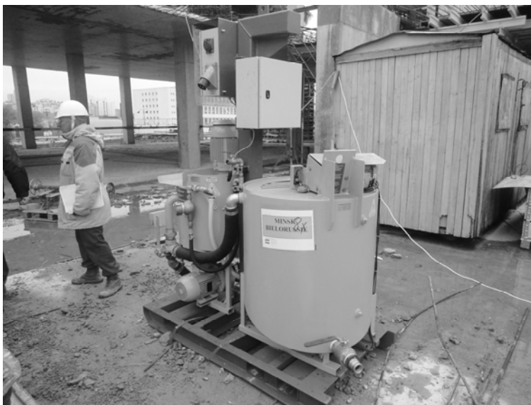
Рис. 4.14. Смесительная станция для приготовления инъекционного раствора. Один из вариантов исполнения
