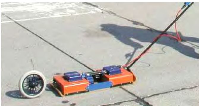
Рис. 1.28. Антенный блок АБ-400 георадара «ОКО» при обследовании взлетно-посадочной полосы
