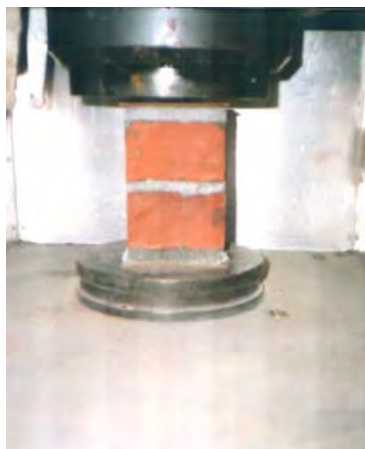
Рис. 5.2. Испытания кирпича керамического: a – на изгиб; б – на сжатие
