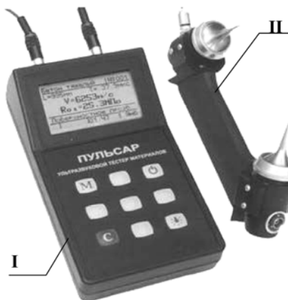
Рис. 1.19. Ультразвуковой прибор «Пульсар-1.0»: I – электронный блок; II – акустический зонд с СТК
