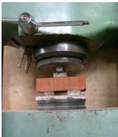
Рис. 5.2. Испытания кирпича керамического: a – на изгиб; б – на сжатие
