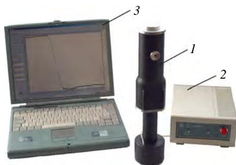
Рис. 1.15. Прибор ИПМ-1А: 1 – ударный преобразователь; 2 – блок АЦП; 3 – компьютер (на экране видна диаграмма изменения скорости движения индентора во времени)
