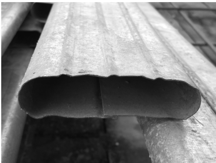
Рис. ПЗ.2. Оболочка-каналообразователь, один из вариантов исполнения
