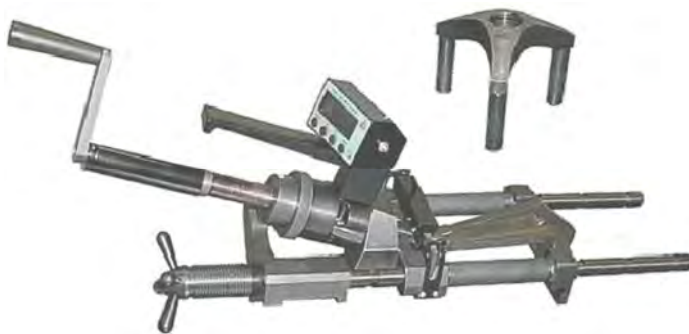
Рис. 1.6. Прибор ПОС-30/50МГ4 «Скол» в сборе для испытаний методом скола ребра
