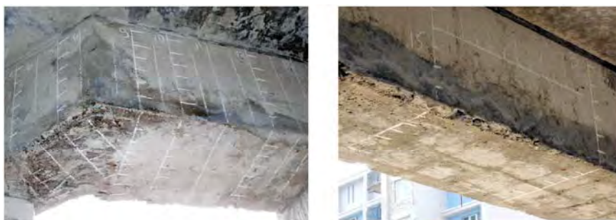
Рис. 1.48. Разметка монолитной балки для ультразвуковых испытаний
