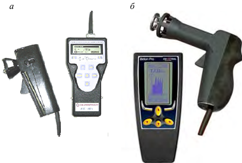
Рис. 1.12. Электронный измеритель прочности бетона: a – прибор ИПС-МГ4.01; б – прибор «Beton Pro»
