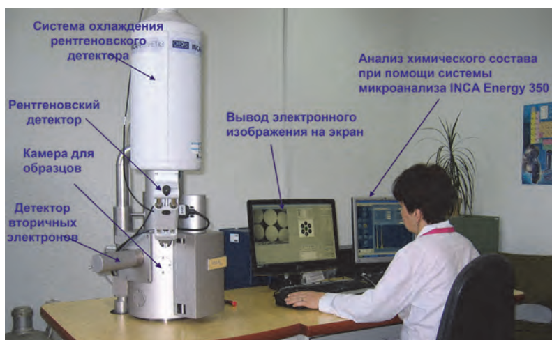
Рис. 3. Растровый электронный микроскоп Tescan Vega II LSH, оснащенный рентгеновским микроанализатором INCA Energy 350
