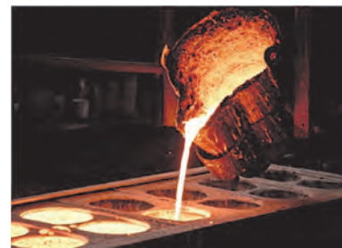
Рис. 1. Заливка литейной формы
