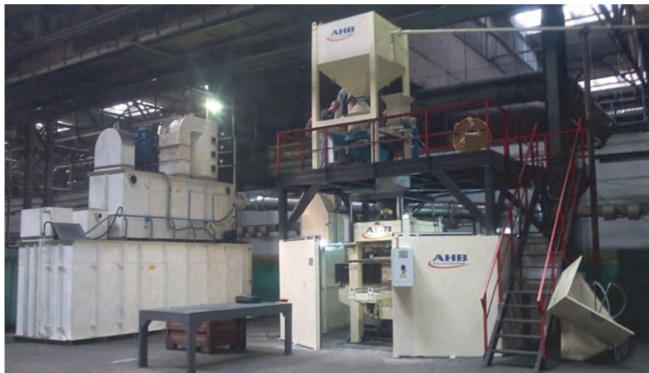
Рис. 9. АБХУ и стержневая машина АНВ, эксплуатируемые на РУП «Гомельский завод литья и нормалей», РБ
