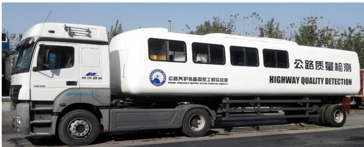
Рисунок 4 – мобильный измерительный комплекс для диагностики дорожных одежд
