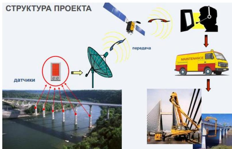
Рисунок 1 – Схема процесса осуществления вибродиагностики
