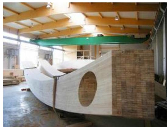
Рисунок 3 – Клееные конструкционные элементы
