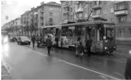
Рис. 2. Остановочный пункт без посадочной площадки, поднятой над уровнем проезжей части
