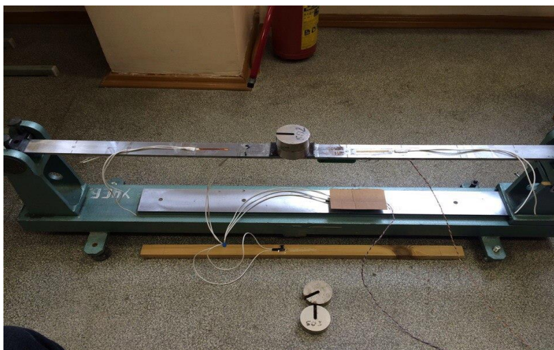
Рисунок 1 – Испытательная установка – балка, с подключенными к ней датчиками
