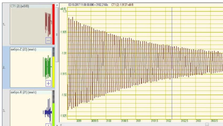
Рисунок 2 – Осциллограмма свободных затухающих колебаний балки при импульсной нагрузке
