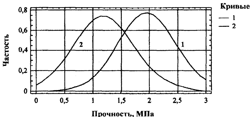
Рис. 6.2. Кривые распределения прочности асфальтобетона: 1 — участки с отсутствием деформаций; 2 — участки с наличием деформаций
