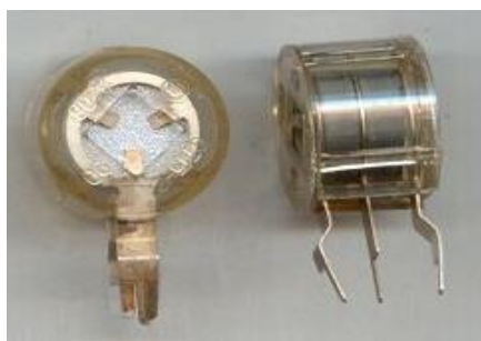
Рисунок 6. Внешний вид резистора СТ15-2-220В с косвенным подогревом
