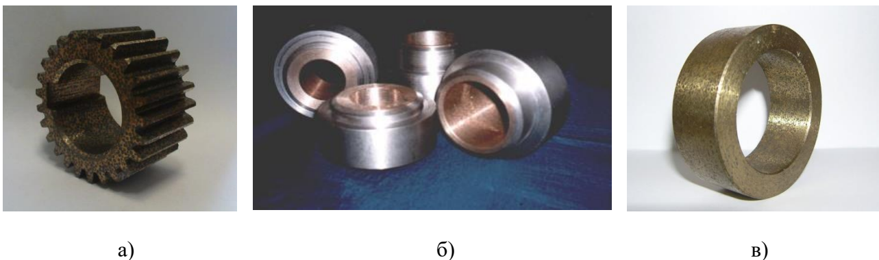
Рисунок 1 – Образцы применения композиционных материалов а) – шестерня, б) – биметаллическая втулка, в) – композиционная втулка для велок компании REG AG (Германия)
