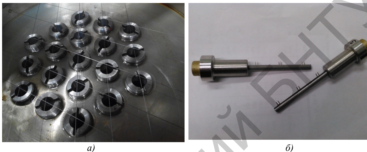
Рисунок 3 – Исследовательская часть измерительной системы: a – сетчатый датчик (верхняя камера); б – стержневые датчики
