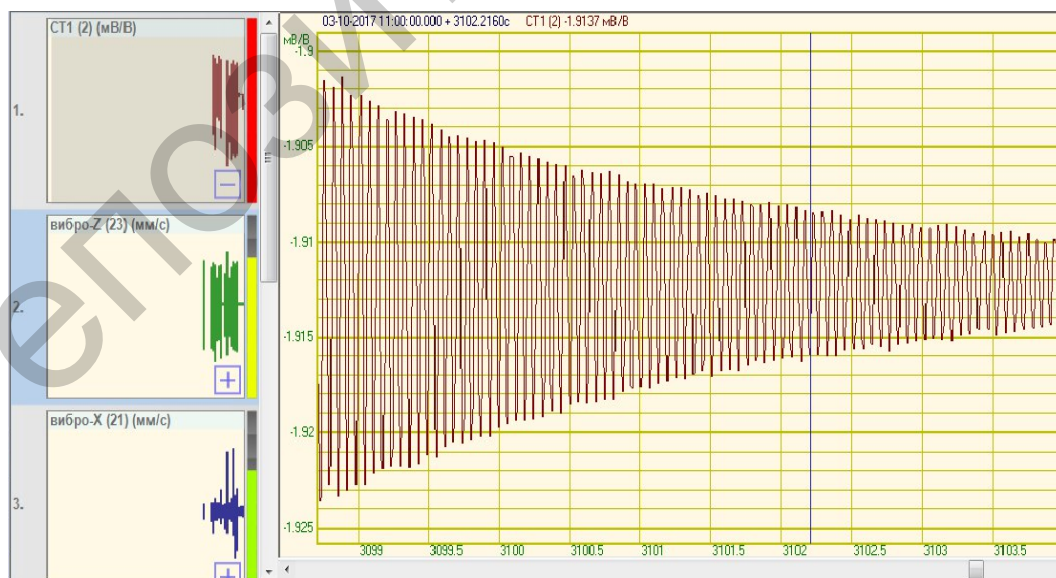
Рисунок 2 – Осциллограмма свободных затухающих колебаний балки при импульсной нагрузке
