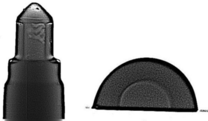
Рисунок 2 – Рентгенограмма биметаллических образцов, полученных при выходном напряжении и токе равных 198 kV-6,3 mA; режимы изготовления образцов V_0 = 70-80 м/с, T_0 = 1150 \pm 20^\circ\text{C}
