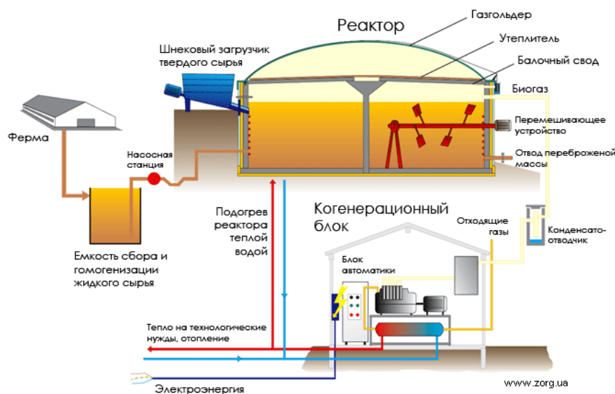
Рисунок 1 – Принципиальная схема получения тепловой и электрической энергии из биореактора с механическим перемешиванием
