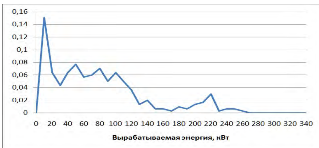
Рисунок 1 – Дневное распределение вырабатываемой электроэнергии. Летний сезон, 6 июля 2016
