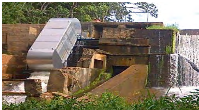
Рисунок 7 – Гидроагрегат мощностью 12 кВт, расходом 400л/с, напор 3,5 м
