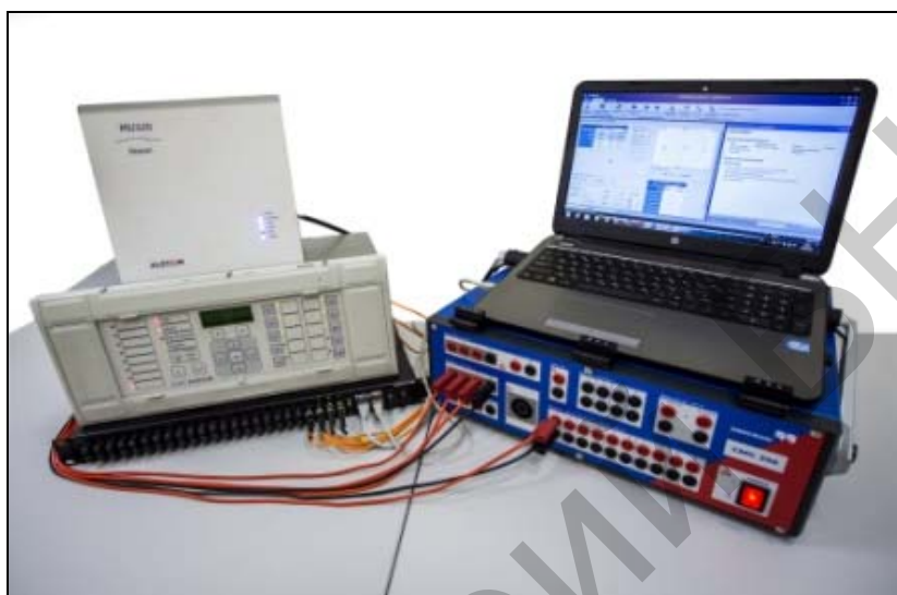
Рисунок 5 – Аппаратно-программный испытательный комплекс на базе устройства СМС 356 компании OMICRON
