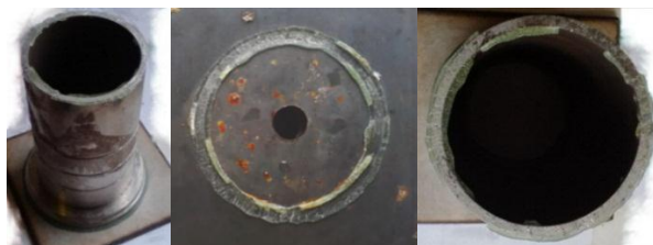
Рисунок 3 – Образец и крышка цилиндра макета после гидравлических испытаний
