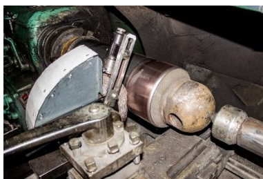
Рисунок 2. Процесс нанесения медного подслоя на рабочую поверхность штока гидроцилиндра.
