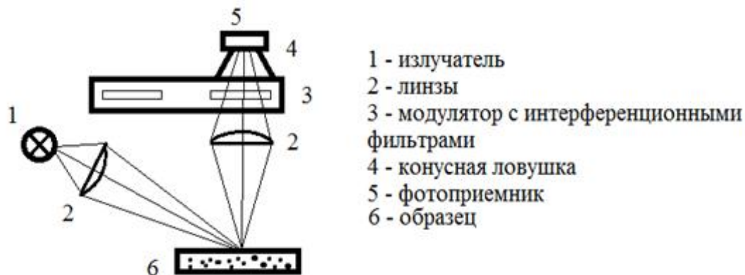
Рис. 1 – Оптическая схема измерителя влажности
