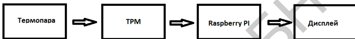
Рис. 2 – Схема измерения термопрофилей пайки
