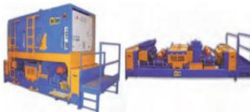
*Машина послойного формования (слипформер) и его сменяющая часть (справа), которая заменяется и налаживается при переходе от одного изделия к другому в течение рабочей смены.*
