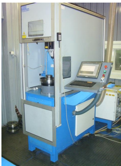
Рис. 2. Установка для упрочнения деталей фрикциона автомобиля БелАЗ на базе оптоволоконного лазера
