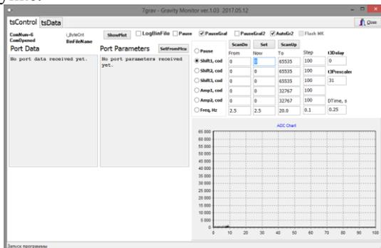
На вкладке tsControl отображаются текущие данные (в текстовом и графическом виде), полученные от измерительного модуля. Здесь же находятся поля задания значений управляющих параметров и кнопки управления. Полученные данные могут быть записаны в двоичный файл (дамп). На вкладке tsData находятся средства извлечения информации (32-разрядных выборок АЦП с частотой 250 или 1000 Гц) из файлов дампа и преобразования ее в текстовый табличный вид.
