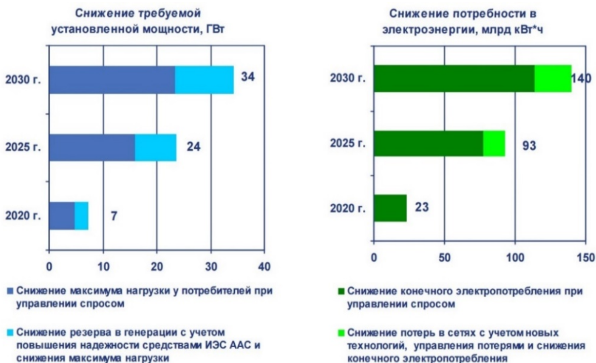
Рисунок 1 – Количественная оценка изменения балансовых условий в ЕЭС России при развитии интеллектуальной энергетики
