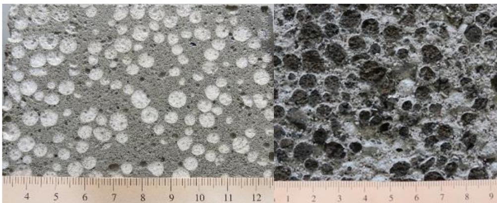
Рисунок 1 – Структура композитного пенобетона с пеностеклом (слева) и керамзитом (справа)
