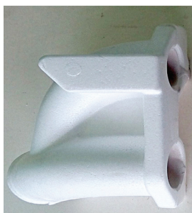
Рис. 5. Литейный вакуумируемый контейнер и модели отливок
