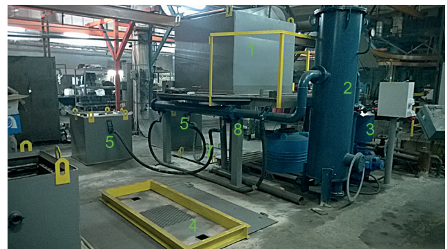
Рис. 3. Формовочно-заливочный участок: а – схема; б – фотография: 1 – сменный раздаточный бункер; 2 – вакуумный аккумулятор; 3 – вакуумный водокольцевой насос; 4 – прямик; 5 – опоки под монорельсом заливочного ковша; 6 – опока на вибростол; 7 – вибростол; 8 – стенд вакуумирования
