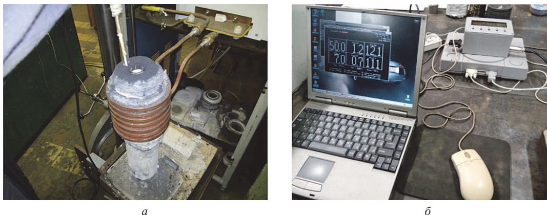
Рис. 1. Высокочастотная индукционная установка (а) и аппаратный комплекс управления процессом плавки (б)
