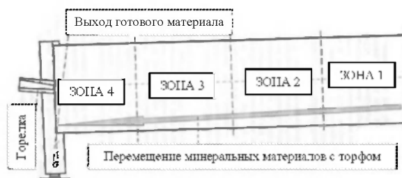
Рис. 3. Зональная физическая модель процессов, протекающих в сушильно-нагревательном барабане
