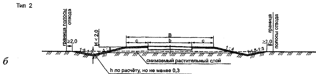
Рис. 6.1. Поперечные профили низких насыпей высотой от 0 до h_{нк} : а – с кювет-резервом на неплодородных землях; б – с кюветом по ценным угодьям
