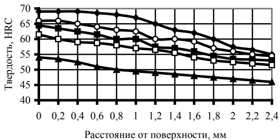
Рис. 1. Изменение микротвердости HV 0,1 по толщине слоя на стали X12Ф1 после цементации при 1000°C, 6 ч в карбюризаторе "Besto" и последующей термообработки
