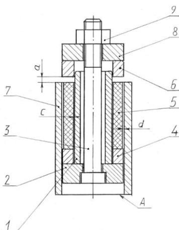
Рисунок 1 – Конструкция оснастки для спекания заготовок из фторкомпозитов методом всестороннего сжатия [5]
