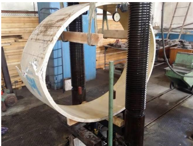
Рис. 5. Характер разрушения образца № 2
