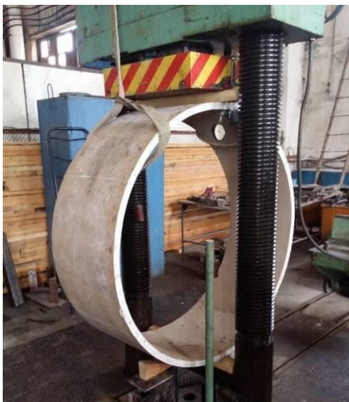
Рис. 3. Образец № 1 при нагрузке при удельной кольцевой деформации 3 %
