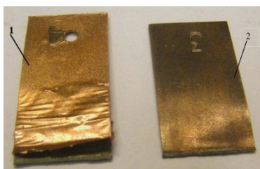
Рисунок 1. Вид поверхности пластин после испытаний на циклический знакопеременный изгиб: 1 – с гальваническим покрытием, 2 – с плакированным покрытием
