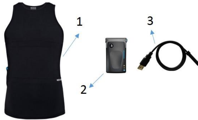
1 – футболка с вплетенными сенсорами; 2 – модуль хранения информации; 3 – кабель для соединения с компьютером
