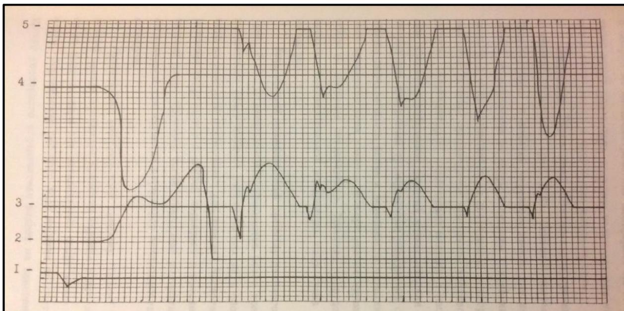
1 – импульс «стартового выстрела, 2, 4 – нормальные к рабочей поверхности стартовой колодки (передней и задней соответственно) составляющие силы реакции опоры, 3, 5 – горизонтальная (продольная) и вертикальная составляющие силы реакции опоры в беговых шагах.
