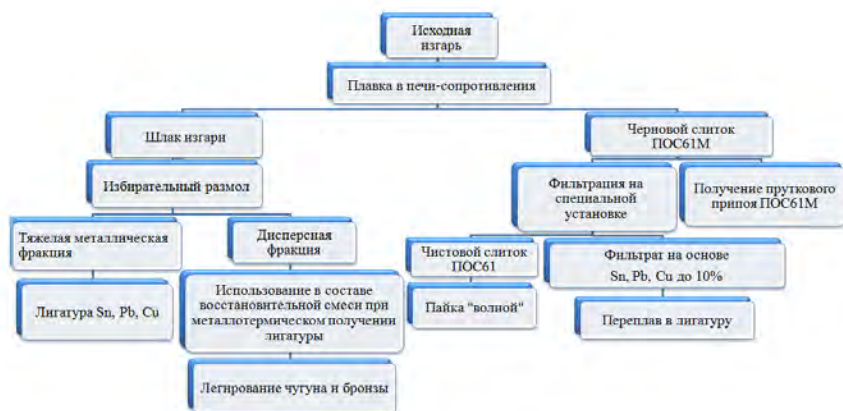
Рисунок 4 – Технологическая схема переработки оловянно-свинцовой изгари
